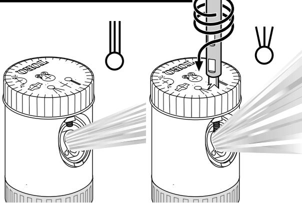
Avvitare la vite dell'ugello per allargare e accorciare il raggio dello spruzzo.
