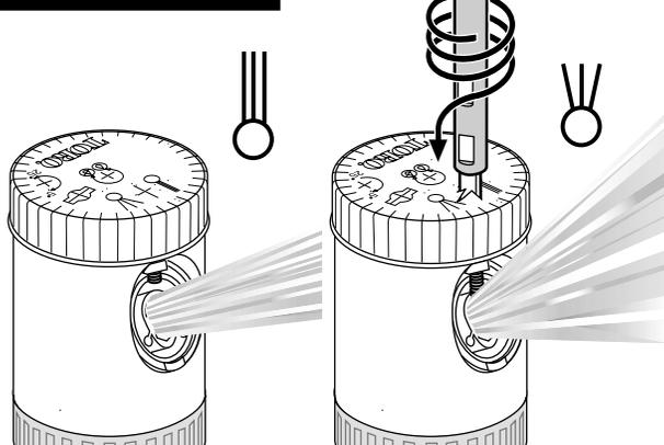
Serrer la vis de la buse pour diffuser le jet et réduire son rayon.
