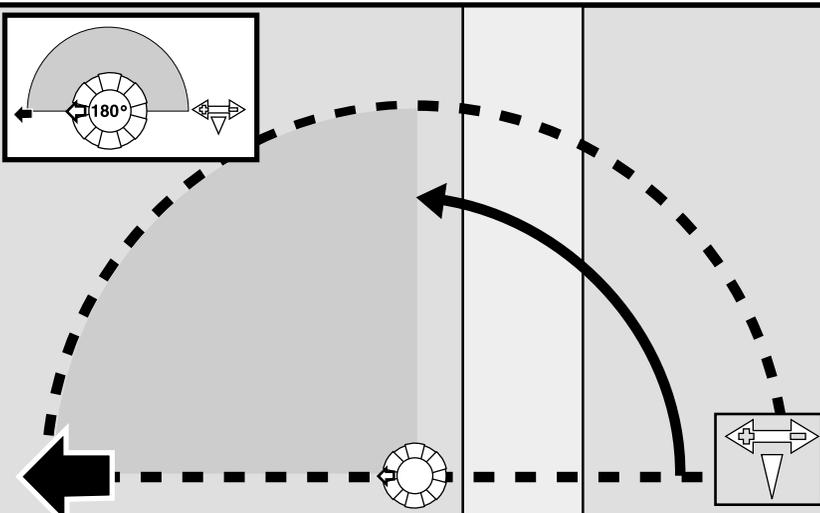
La zone d'arrosage est délimitée par la flèche du capuchon et la flèche de butée droite située sur la bague de réglage de l'arc. Dans cet exemple, elle est réglée sur 180°.
