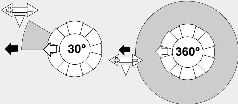
Girare l'anello di regolazione dell'arco per allineare la freccia bianca con il lato destro dell'arco di irrigazione.
