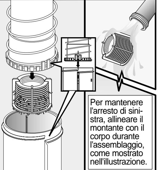
Per mantenere l'arresto di sinistra, allineare il montante con il corpo durante l'assemblaggio, come mostrato nell'illustrazione.
