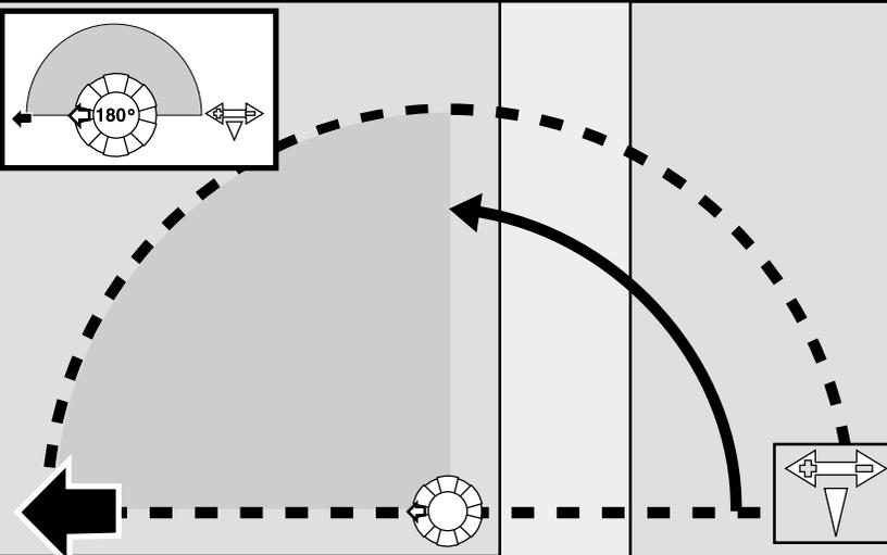
L'area di irrigazione si trova fra la freccia del cappuccio e la freccia di arresto destra sull'anello di regolazione dell'arco. Questo esempio è impostato a 180°.
