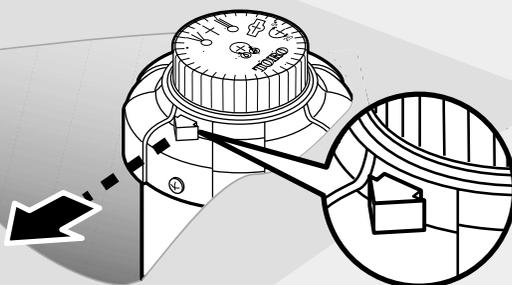
L'angle de la zone d'arrosage peut se régler entre 30 et 360°. Quand il est réglé sur 360°, la buse ne fait pas de va-et-vient.
