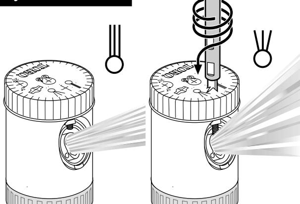
Gire o parafuso do bico para dentro a fim de abrir (espalhar) e encurtar o raio do borrifo.
