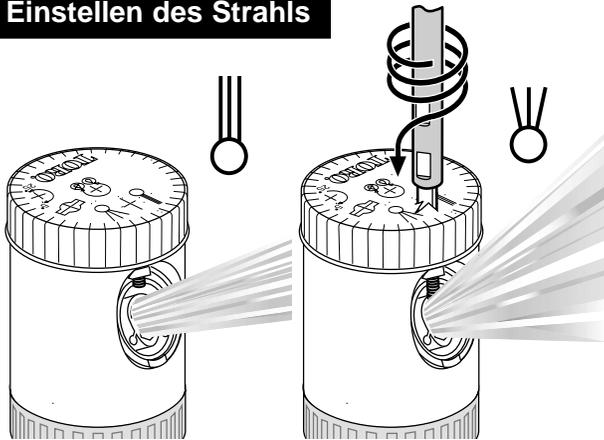
Die DüSENSCHRAUBE hineindreihen, um den Strahl zu zerstäuben und den Regnerradius zu verkürzen.
