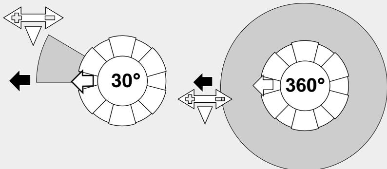
Tourner la bague de réglage de l'arc pour faire correspondre la flèche de butée droite au bord droit de l'arc d'arrosage.
