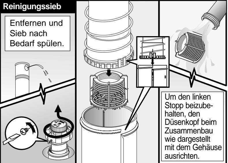
Um den linken Stopp beizubehalten, den Düsenkopf beim Zusammenbau wie dargestellt mit dem Gehäuse ausrichten.
