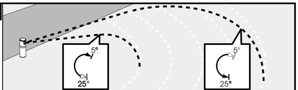
L'angolo della traiettoria dell'ugello può essere regolato fra 5° e 25°. Inserire l'estremità affilata dello spruzzatore, oppure un cacciavite, attraverso il cappuccio. Girare la vite di regolazione verso destra per diminuire l'angolo e accorciare il raggio dello spruzzo, oppure girarla verso sinistra per aumentare l'angolo e allungare il raggio.
