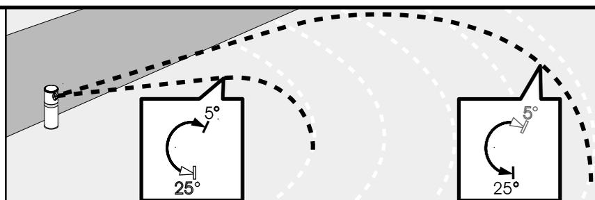
O ângulo da trajetória do bico pode ser ajustado entre 5 e 25°. Insira a extremidade da lâmina da ferramenta do irrigador automático ou uma chave de fenda através da tampa. Gire o parafuso de ajuste para a direita quando quiser diminuir o ângulo e reduzir o raio de borifo, ou para a esquerda quando quiser aumentar o ângulo e alongar o raio de borifo.
