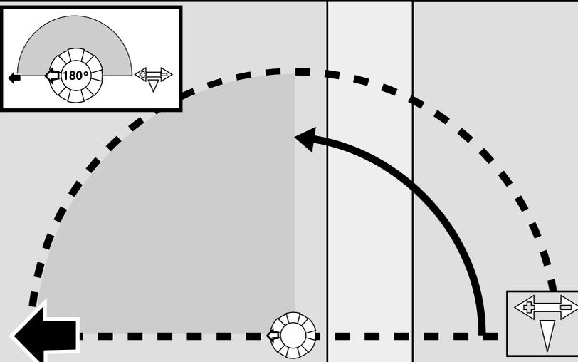
A área de irrigação encontra-se entre a seta da tampa e a seta de parada direita no anel de ajuste de arco. Este exemplo faz o ajuste para 180°.
