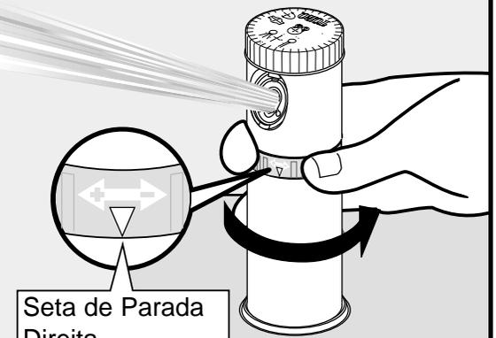
A área de irrigação pode ser ajustada entre 30 e 360°. Quando o ajuste for feito para uma área de 360°, o bico não reverte a direção.
