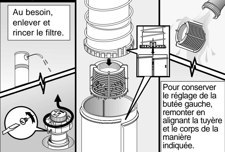
Pour conserver le réglage de la butée gauche, remonter en alignant la tuyère et le corps de la manière indiquée.
