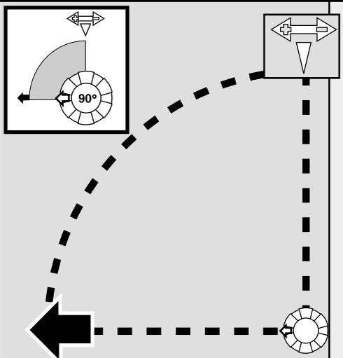
Allineare la freccia di arresto destra con il lato destro dell'arco di irrigazione.
