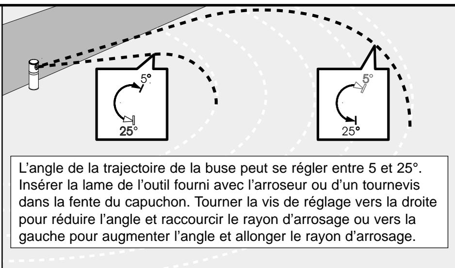
L'angle de la trajectoire de la buse peut se régler entre 5 et 25°. Insérer la lame de l'outil fourni avec l'arroseur ou d'un tournevis dans la fente du capuchon. Tourner la vis de réglage vers la droite pour réduire l'angle et raccourcir le rayon d'arrosage ou vers la gauche pour augmenter l'angle et allonger le rayon d'arrosage.
