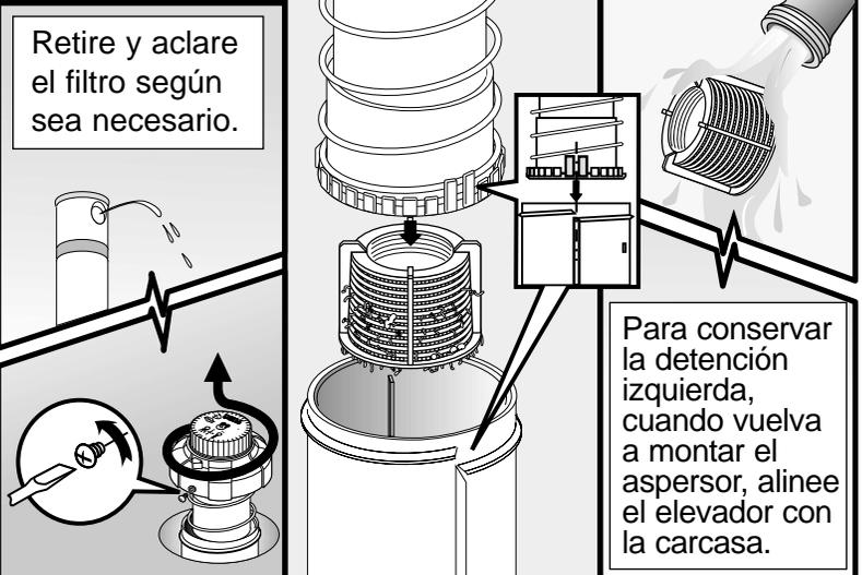
Para conservar la detención izquierda, cuando vuelva a montar el aspersor, alinee el elevador con la carcasa.
